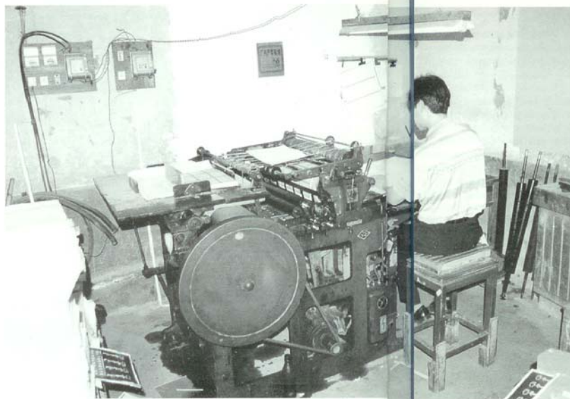
Nummereren op een cilinder van Chinees fabriek.
